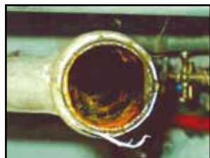
Verzinktes Verteilerrohr vor und nach der Behandlung mit WELLAN® 2000 in einem Privathaushalt.
